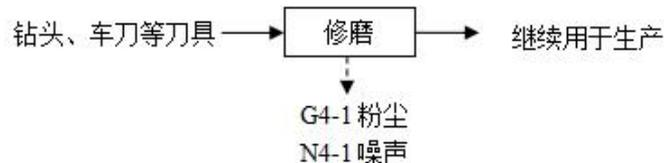
图 2-6 刀具修磨生产工艺流程图
